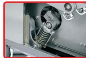
Il mollettone di recupero pressione dà la possibilità di ridurre al minimo lo stress che l'azione meccanica della macchina dà alla pasta. Tutto questo unito al sistema di spezzatura a stella permette alla macchina di utilizzare il sistema STOP-STRESS-SYSTEM.
