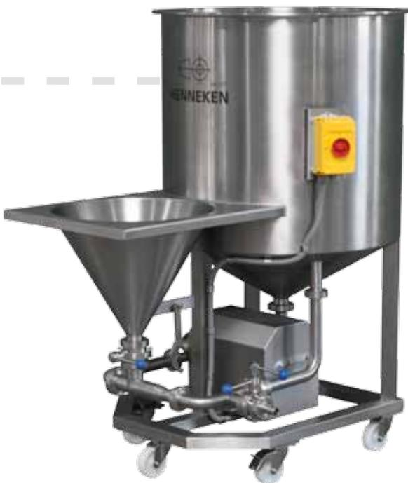
Los ingredientes a mezclar con el agua son succionados y mezclados uniformemente y sin grumos.
